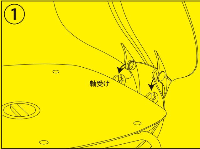
座面に後方にある軸受けに、ヘルメットと背板の間にある金具を②のような角度で差し込んで下さい。
